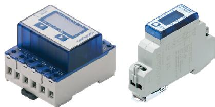
I Contatori di Energia monofase e trifase a lettura diretta o attraverso TA, con interfaccia seriale Rs485 integrata e protocollo Saia S-Net permettono la lettura diretta dei dati rilevanti quali, Energia (totale e parziale), corrente e tensione per ogni fase, potenza attiva e reattiva. Sono conformi alla direttiva MID per gli strumenti di misura e hanno una precisione di classe 1 (IEC 62 053-21).
